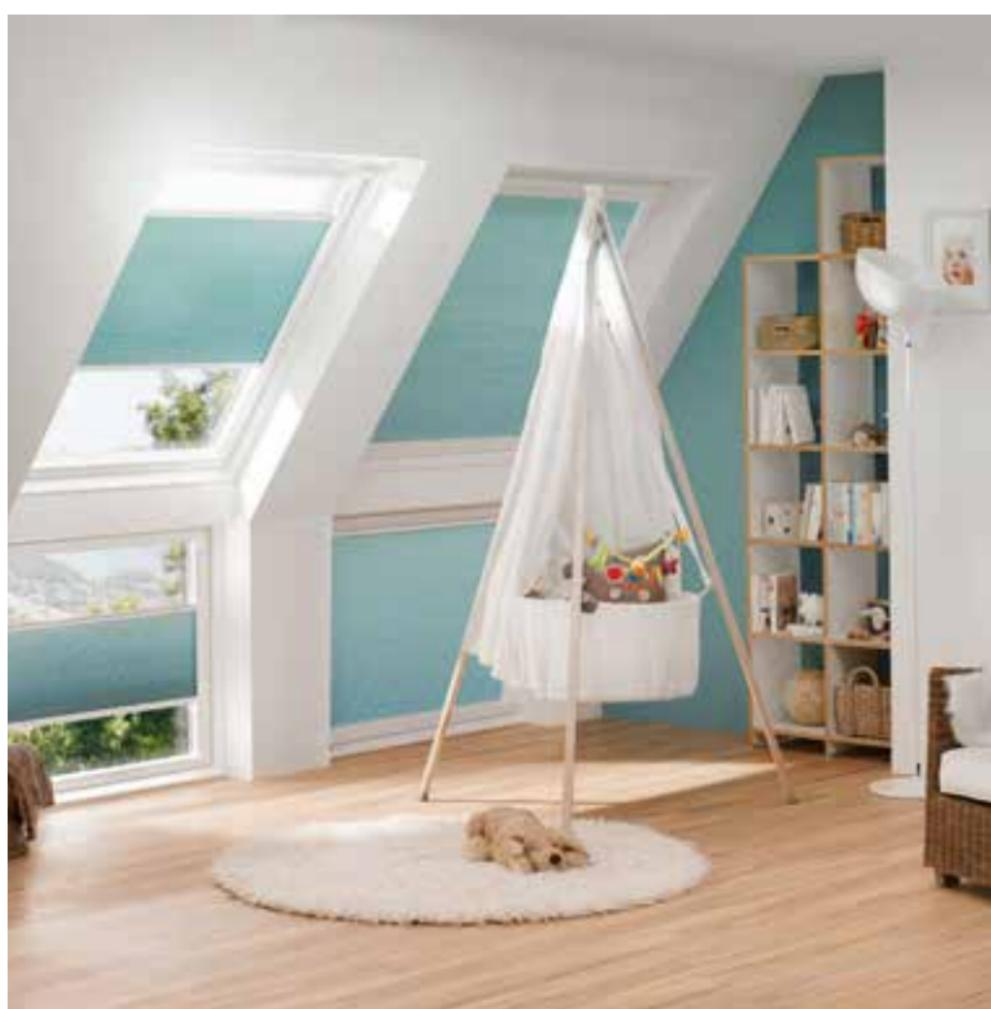
*Les stores alvéolaires constituent une protection idéale contre la chaleur sous les combles. Sur les fenêtres de toit, leur montage direct et précis sur le cadre augmente leur effet protecteur, car l'échange d'air entre le store et la vitre s'en trouve réduit.*
